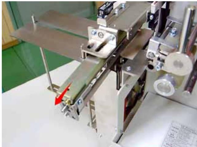
5 , 新しいカッター刃を取り付けます , この時に刃に付いているギヤのネジ部が真上に向いた状態でカッターモーター側のギヤと噛み合わせます。
