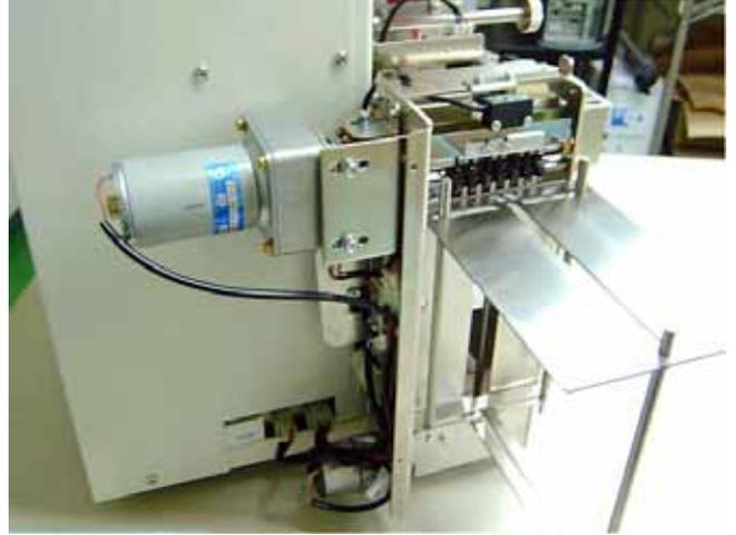
2, カッター手前の黒いプラスチックネジを手で外し, 金具を手前にスライドさせ外します。
