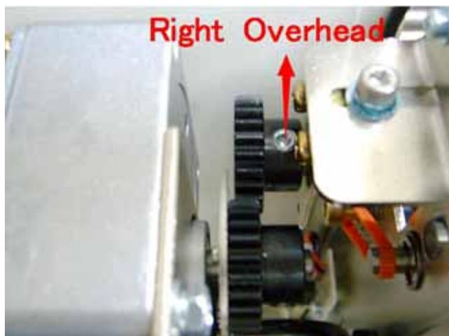
6 , 2箇所 のネジを締め付ける時に必ずカッター刃ギヤとモーター側ギヤ円盤との間に1mm程度の隙間をあけた状態で締め付けてください。
