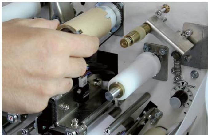
**1** 第1ヘッドのインクリボン巻き取り部に紙管を装着します。
