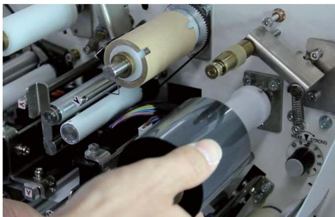
**2** 新しいインクリボンを装着してルート図のとおり透明フィルムを通します。
