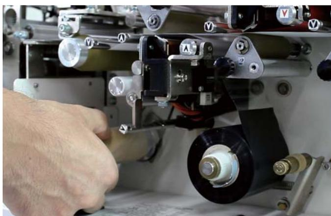
ルート図のとおり透明フィルムを通して、巻き取り側の紙管にセロハンテープで貼り付けます。
