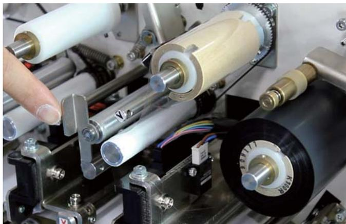
**4** レバーを手前に引いて制御押さえローラーをセットします。
