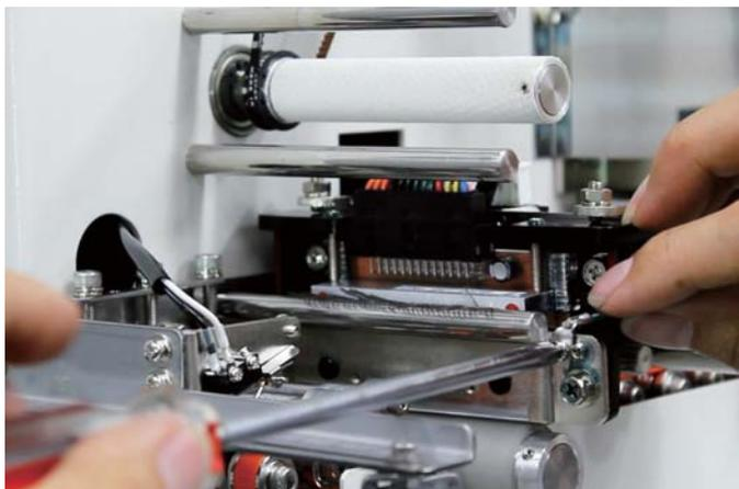
**1** プリンタの電源を切り、インクリボンを取り外しておき、ヘッドアースをはずします。
