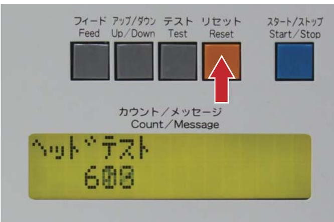
**9** プリンタ本体の電源を入れます。ヘッドテストが開始されるので [リセット] スイッチを押してテストを回避します。
