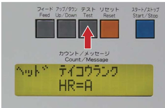
交換前のヘッド抵抗値である「A」が表示されていますので新しいヘッドの抵抗値「7」に変更します。
