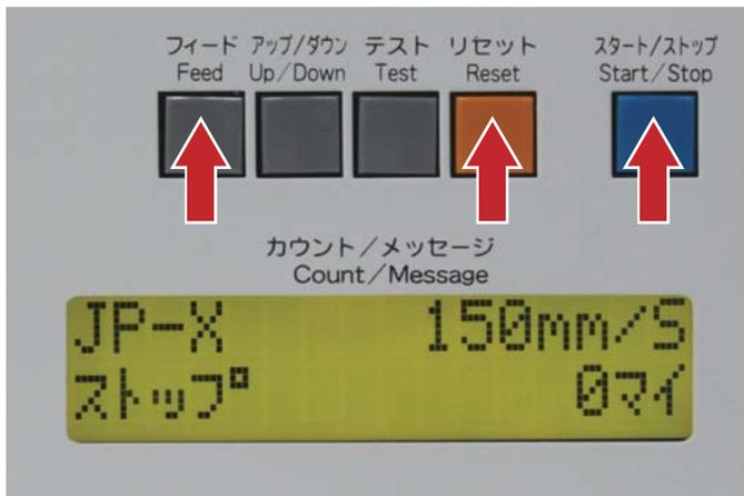
「ストップ」の文字が表示されている状態で[リセット]スイッチを押したまま[スタート]スイッチと[フィード]スイッチを押します。
