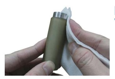
毛羽立たない不織布と純正クリーナー液を 使用して印字ローラーの汚れを拭き取りま す。
