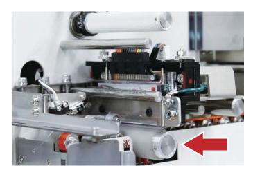
マッドを拭き終わったらヘッド保護カバーをし、印字ローラーを取付けます。
