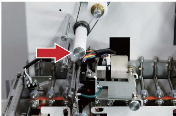
**4** 逆手順で制御ローラーを装着し、制御ローラーの端と軸の端が平面になる箇所で固定して完了です。
