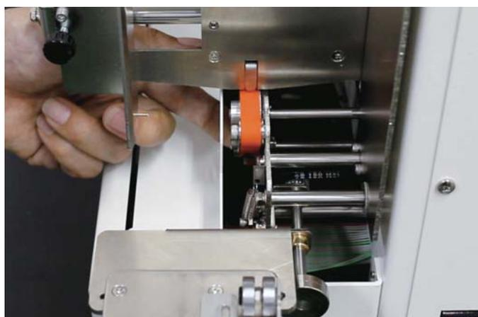
指で回転させながら給紙側から毛羽立たない不織布などに純正クリーナー液を染み込ませて汚れが付かなくなるまで拭きます。
