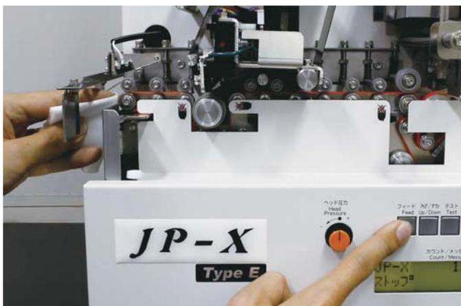
ベルトが露出している部分に不織布を当て、汚れが落ちるまでフィードを続けます。
