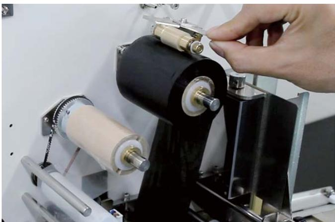
インクリボンのたるみを手で巻き取って、ブレーキローラーを降ろします。
