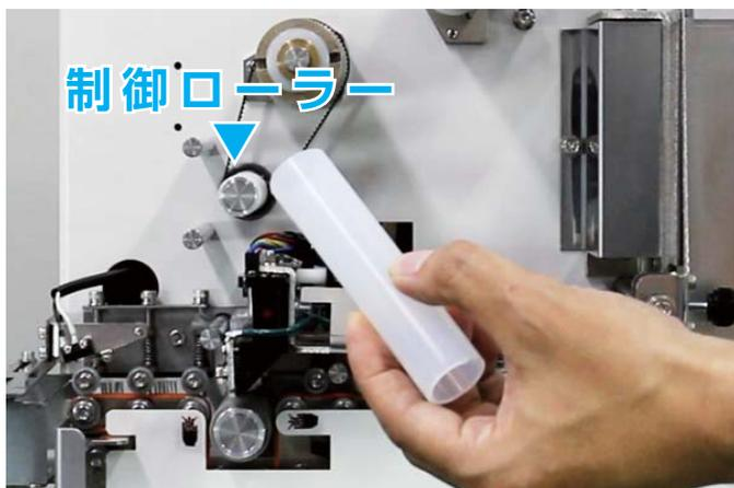
**2** インクリボンセット補助パイプを制御ローラーに装着します。
