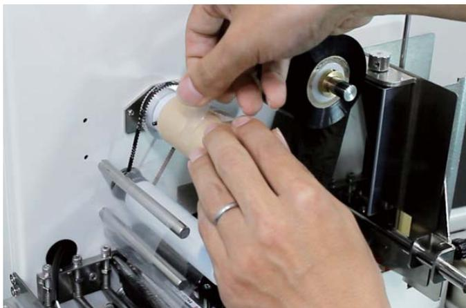
巻き取り側の紙管に透明フィルムの先端をセロハンテープで貼り付けます。
