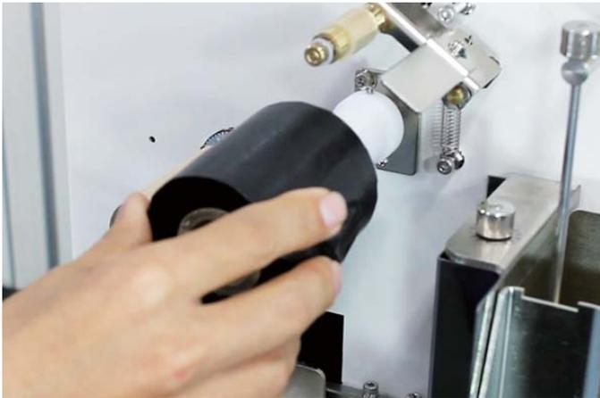
**3** 新しいインクリボンを装着してルート図のとおり透明フィルムを通します。
