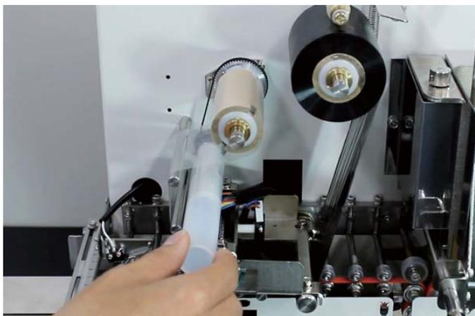
**4** インクリボンセット補助パイプを引き抜きます。
