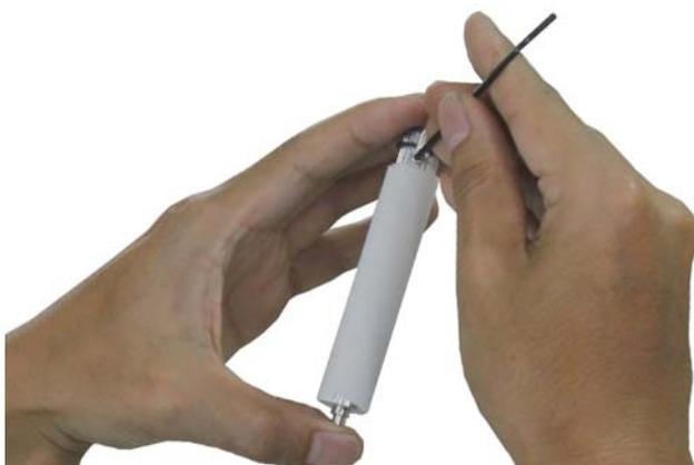
**5** 新たな制御ローラーにプーリーを取付けます。
