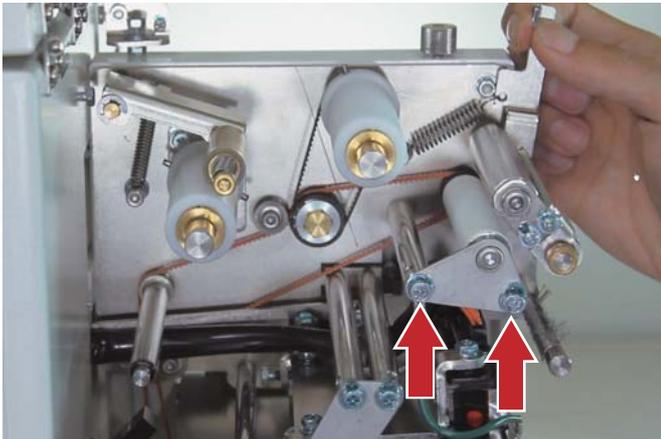
**2** ネジを2点はずし、金具を抜き取ります。
