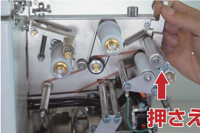
**1** プリンタの電源を切り、インクリボンを取り外しておき、押さえローラーを上げます。
