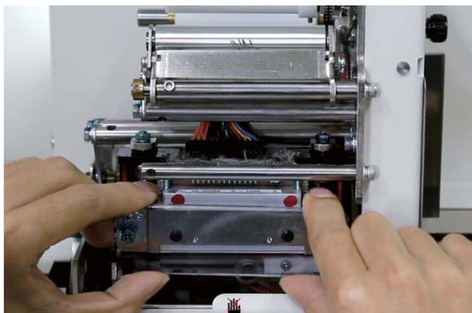
**8** ヘッドを拭き終わったらヘッド保護カバーをし、印字ローラーを取付けます。
