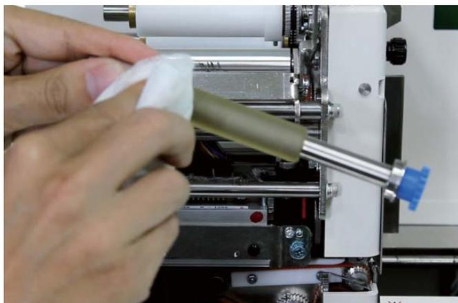
**7** 毛羽立たない不織布と純正クリーナー液を使用して印字ローラーの汚れを拭き取ります。
