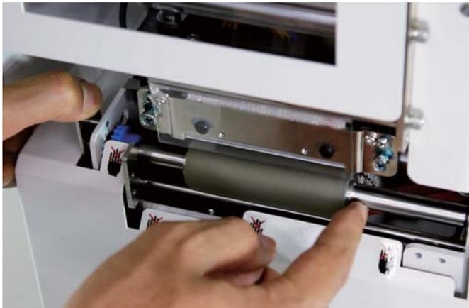
シリアル番号下四桁が 6378 以降の Jupiter712 Type E は青いギア左の金具を開いて印字ローラーを左に押してから右手前に引き抜きます。
