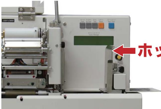
**1** プリンタの電源を切り、インクリボンを取り外しておき、ホッパーを全開にします。
