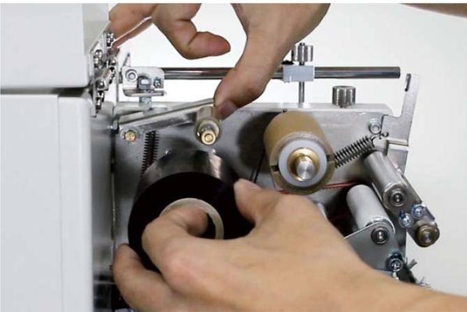
ブレーキアームを持ち上げてインクリボンを巻取り側と同じ色のピンにセットします。
