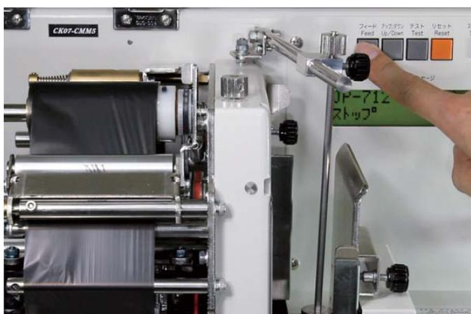
**4** 液晶パネルに「ストップ」と表示されていることを確認し、[フィード] ボタンを押してインクリボンのたるみを取ります。
