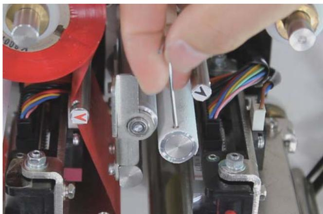
**2** 六角ネジを 1 箇所ゆるめてローラーを抜き取ります。
