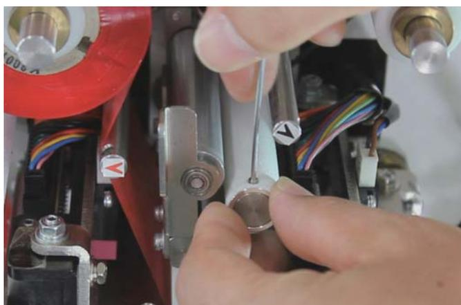
**3** 制御ローラーの白いシート部分をできるだけ持たないようにして差し込み、固定します。
