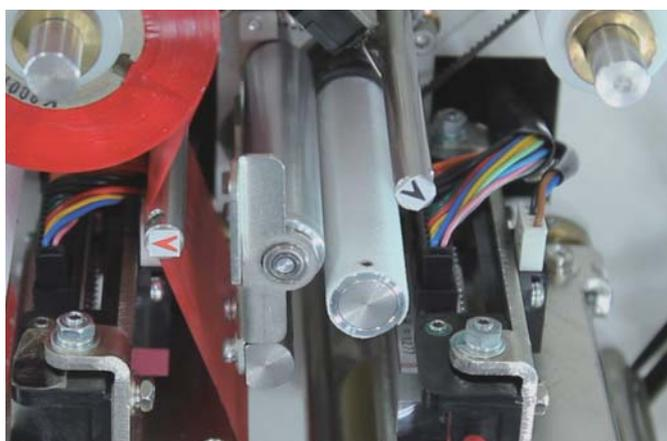
**4** 制御ローラーの端と軸の端が平面になる場所で固定して完了です。
