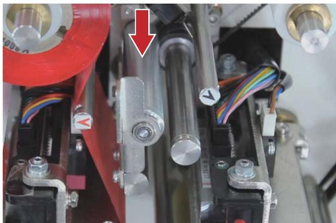
押さえローラーにインク汚れが付着している場合は純正クリーナー液を使用して拭き取ります。
