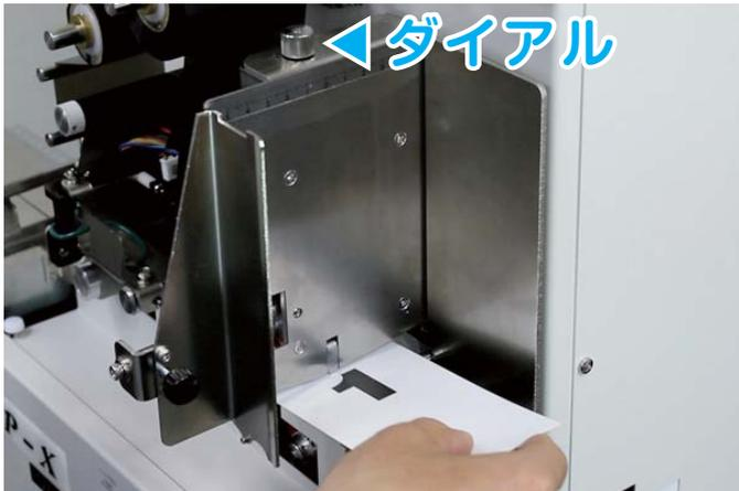
**2** 用紙の厚みを計り、1.6枚分の用紙の高さにゲートを合わせます。
