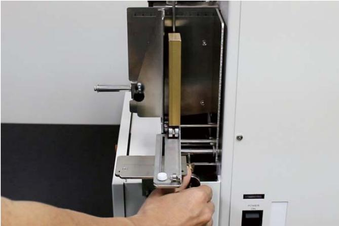
**1** 用紙の厚みに応じてゲートの高さを調節するためにホッパーを開いておきます。
